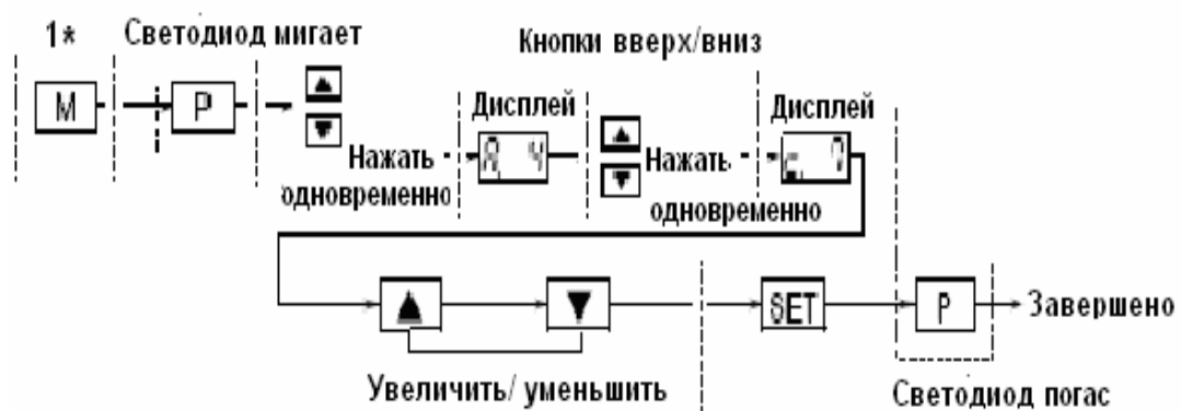
Рисунок Ж.2 – Алгоритм настройки яркости дисплея
