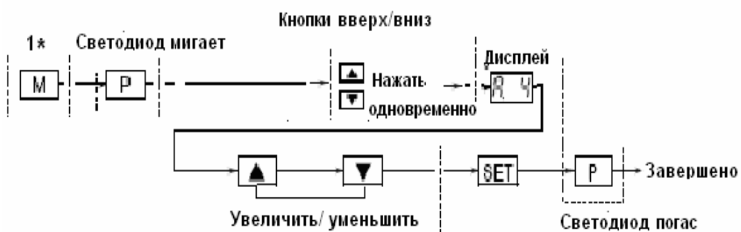
Рисунок Ж.5 - Алгоритм установки времени усреднения результата измерения (цифрового фильтра) для модели DT NDV
