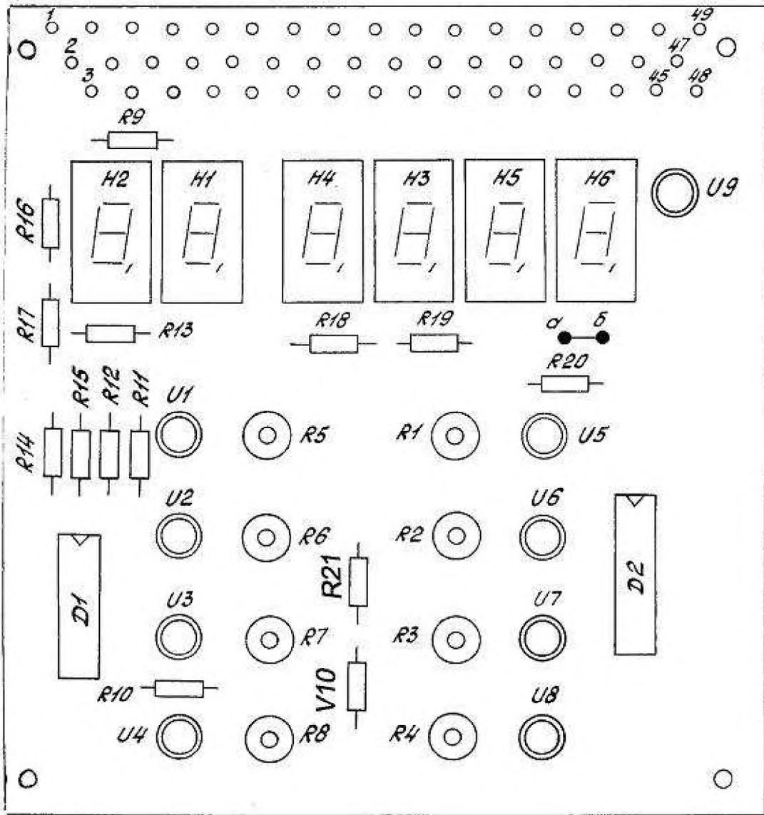
Рисунок 9 – Плата индикации
