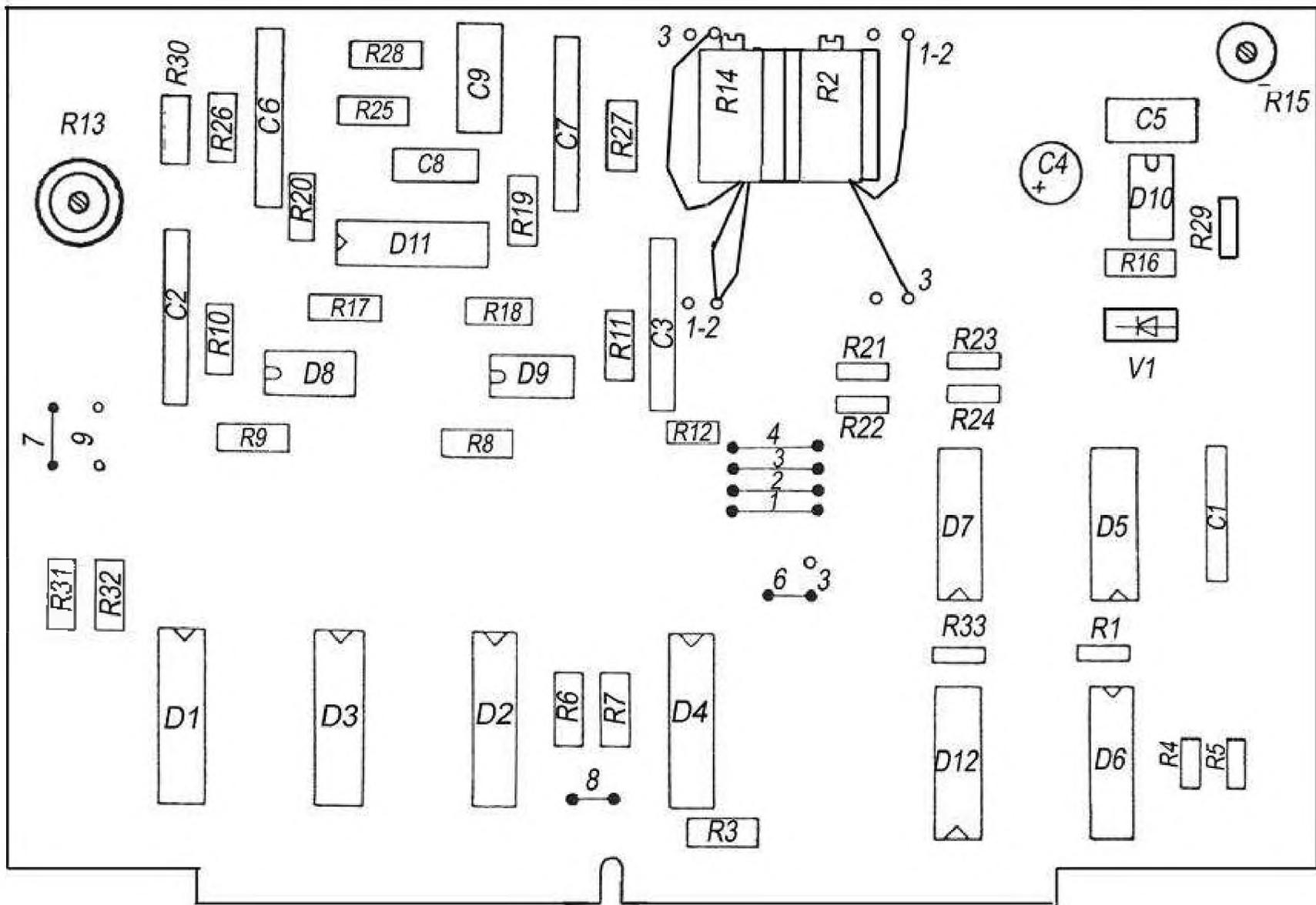
Рисунок 7 – Плата усилителя
