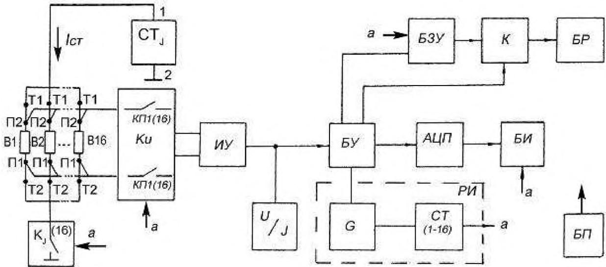
В1-В16 - термопреобразователи сопротивления; СТJ - стабилизатор тока; Тп, Пп - токовые и потенциальные провода подключения ТС; КJ,КУ - ключи тока и напряжения; ИУ - измерительный усилитель; U/J - преобразователь напряжения в ток; БУ - блок управления; G - генератор; СТ - счетчик с переменным коэффициентом деления; РИ - распределитель импульсов; АЦП - аналого-цифровой преобразователь; БИ - блок индикации; БЗУ - блок задания уставок; К - блок компараторов; БР - блок реле; БП - блок питания
