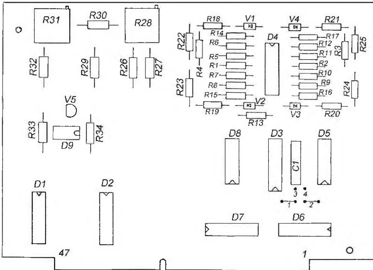
Рисунок 6 – Плата компаратора
