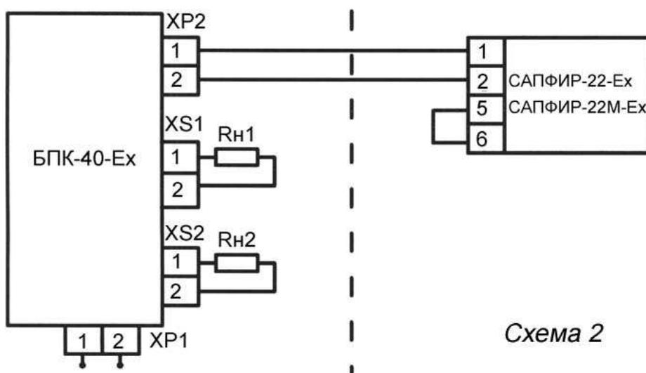
**ВНИМАНИЕ!** Для нормальной работы блока при использовании только одного выходного канала (или с пропорциональной, или с корнеизвлекающей зависимостью) необходимо закоротить выход неиспользуемого канала.
