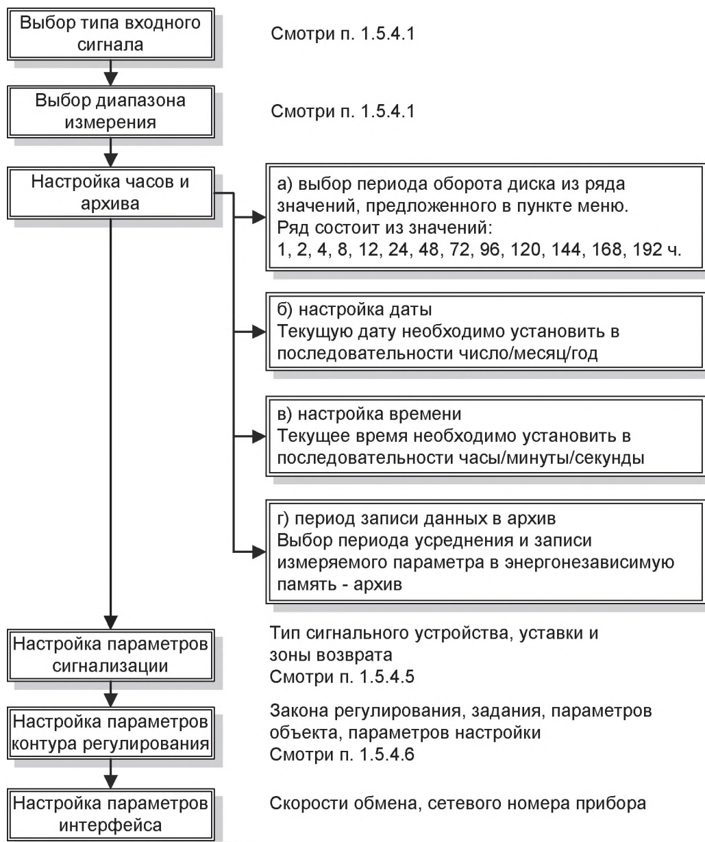
Рисунок 6 – Этапы настройки прибора
