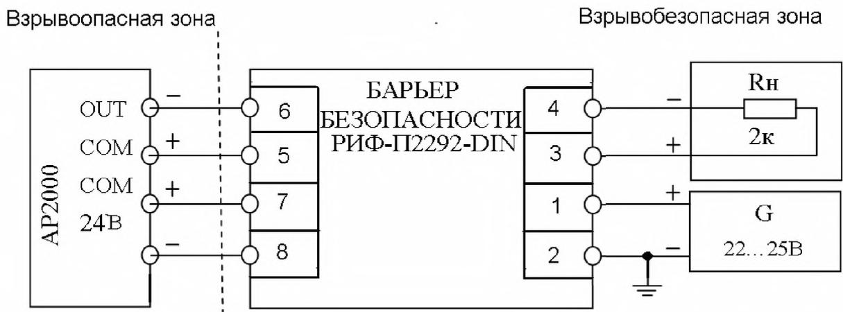
**Рисунок Ж.19** – Схема подключения ПВТ (AP2000) и барьера безопасности РИФ-П2292-DIN
