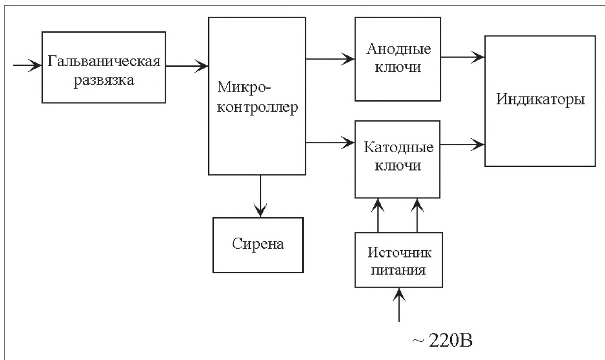
Рисунок 2 – Структурная схема выносного табло
