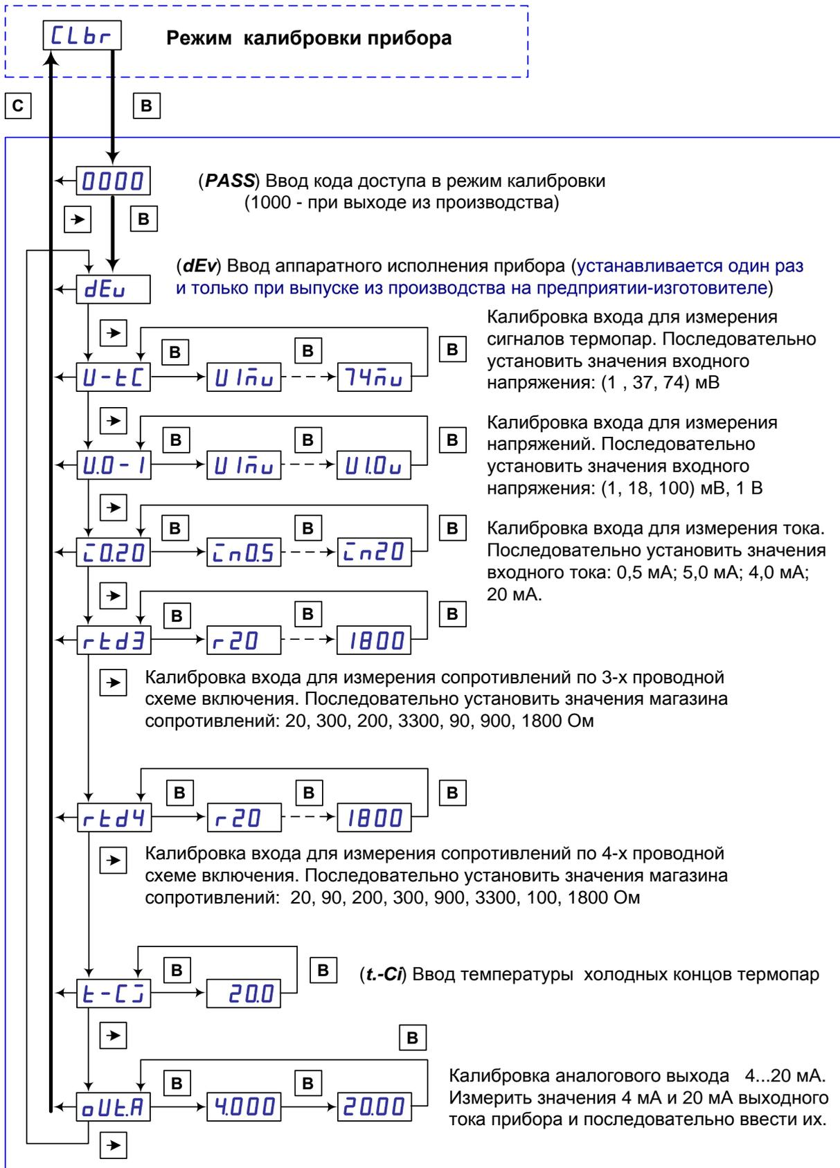
Рисунок 40 – Схема входа в режим калибровки прибора
