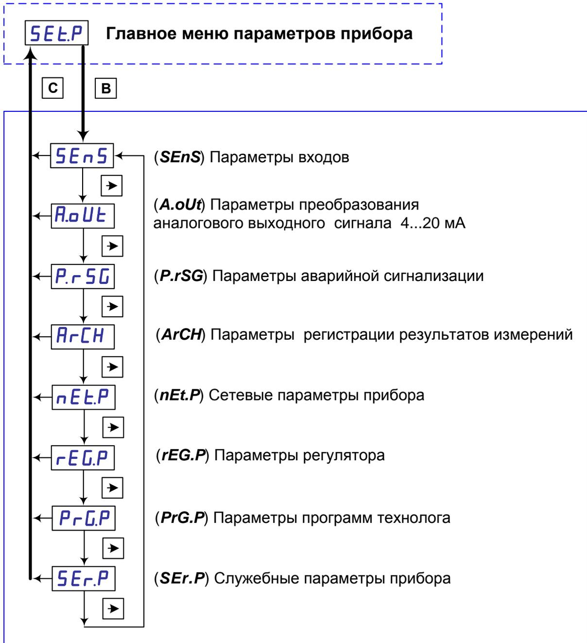
Рисунок 27 – Схема выбора групп рабочих параметров прибора.
