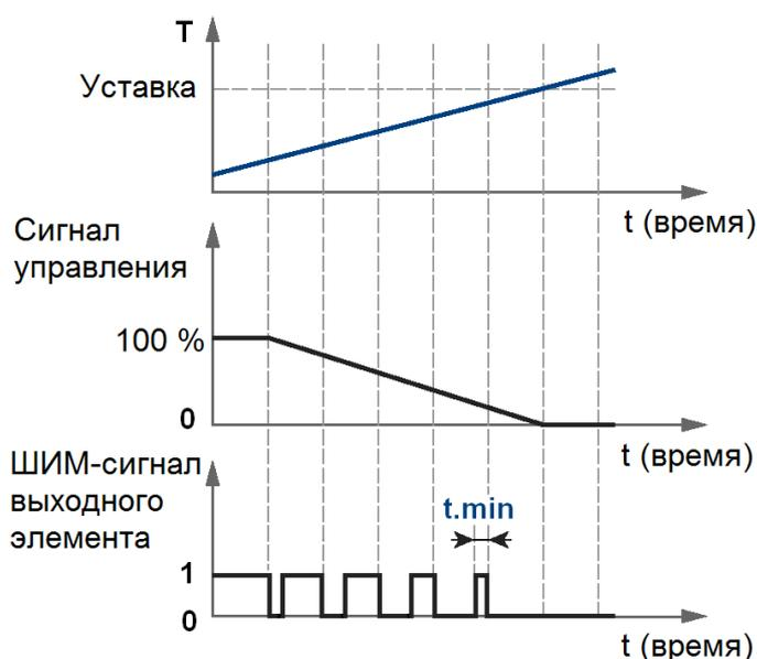
Рисунок 9 – Принцип формирования ШИМ-сигнала для «нагревателя»
