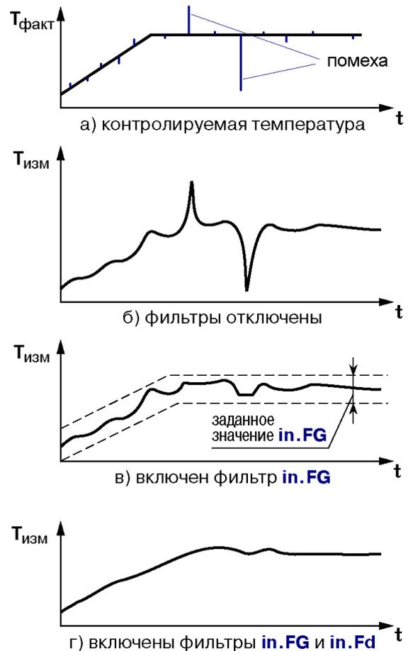
Рисунок 3 – Временные диаграммы работы цифровых фильтров
