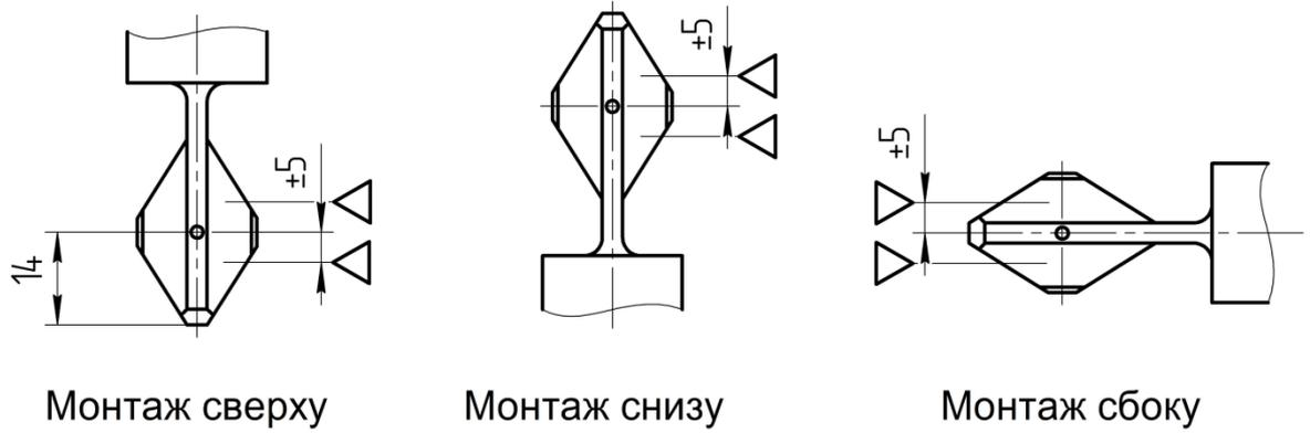
Рисунок 7 – Точки срабатывания сигнализатора
