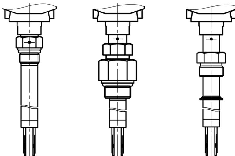
Рисунок 6 – Расположение маркировки относительно лопаток сенсора
