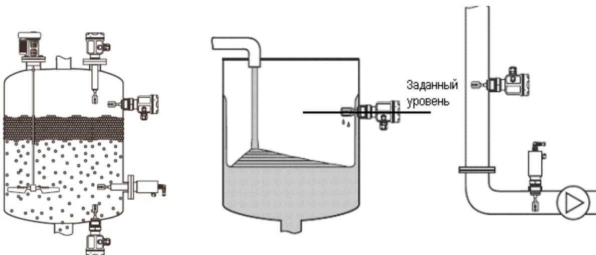
Рисунок 1 – Примеры применения сигнализатора
