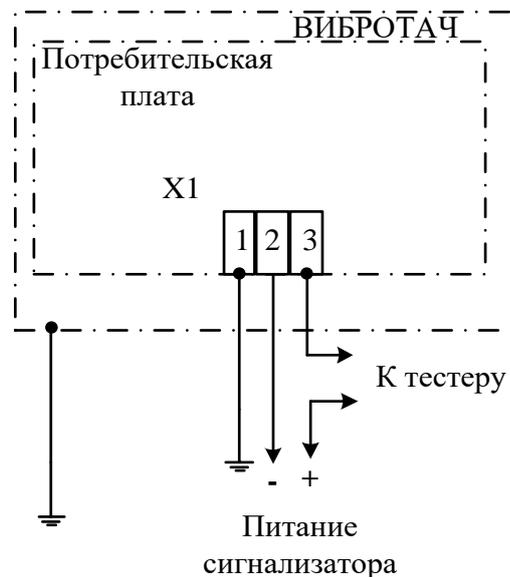
Рисунок 12.4 – Схема подключений для проверки функционирования сигнализаторов исполнений 52\* и 56.
