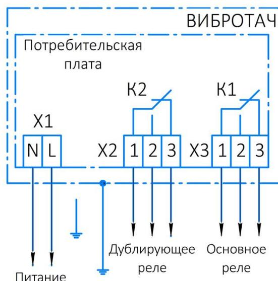
Рисунок 11.2 – Схема внешних подключений сигнализатора с релейным выходом (обозначение исполнения 54, 55)
