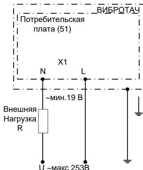
Рисунок 11.1 – Схема внешних подключений сигнализатора с токовым выходом (обозначение исполнения 51)
