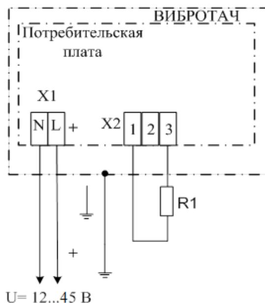
Рисунок 11.3 – Схема внешних подключений сигнализатора с выходом «постоянный ток» (обозначение исполнения 52)
