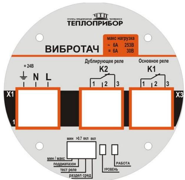
Рисунок 4.5 – Фальшпанель для сигнализатора с исполнением электроники 52\*
