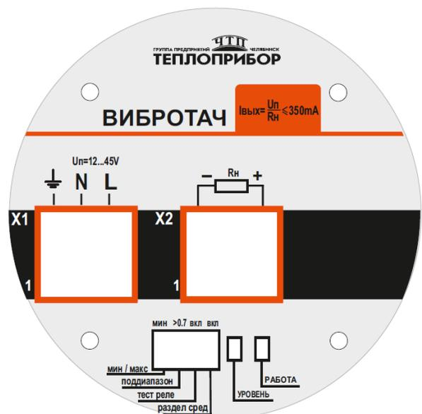
Рисунок 4.4 – Фальшпанель для сигнализатора с исполнением электроники 56
