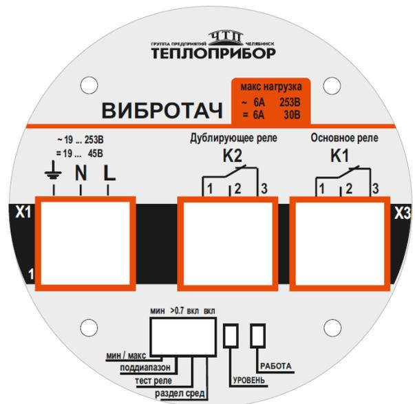
Рисунок 4.3 – Фальшпанель для сигнализатора с исполнением электроники 52
