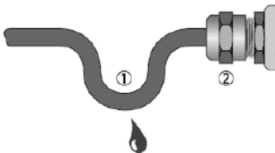
Рисунок 10 – Правила прокладки и присоединения кабеля в соответствии со степенью защиты IP66/ IP67/ IP68
