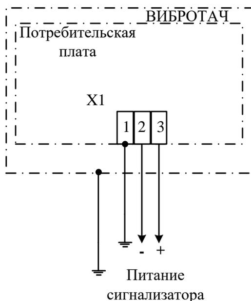
Рисунок 11.4 – Схема внешних подключений сигнализатора с выходом Namur L-N (обозначение исполнения 56) и двухпроводного токового сигнала (исполнение 52\*)
