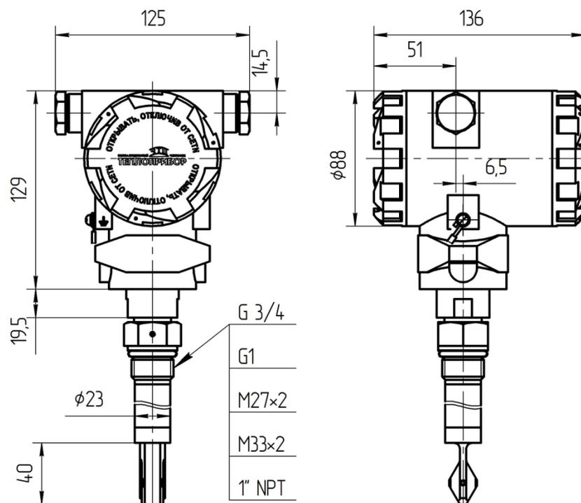
Длина измерительной части L, в зависимости от технологического присоединения:
