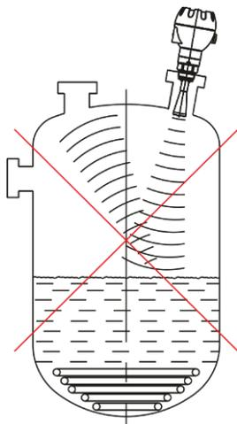
Рисунок 7 – Выравнивание антенны
