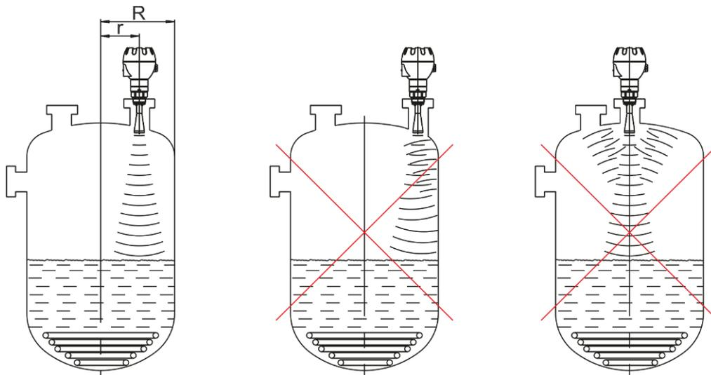
Рисунок 3 – Размещение прибора
