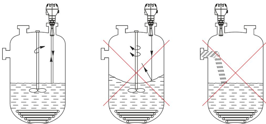
Рисунок 4 – Движение на поверхности жидкости
