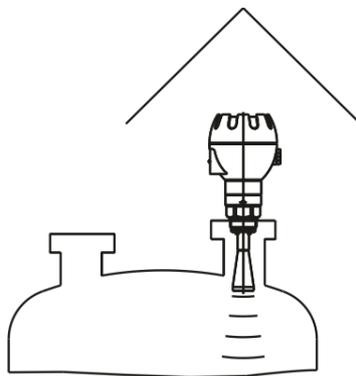
Рисунок 9 – Обеспечение защиты от перегрева
