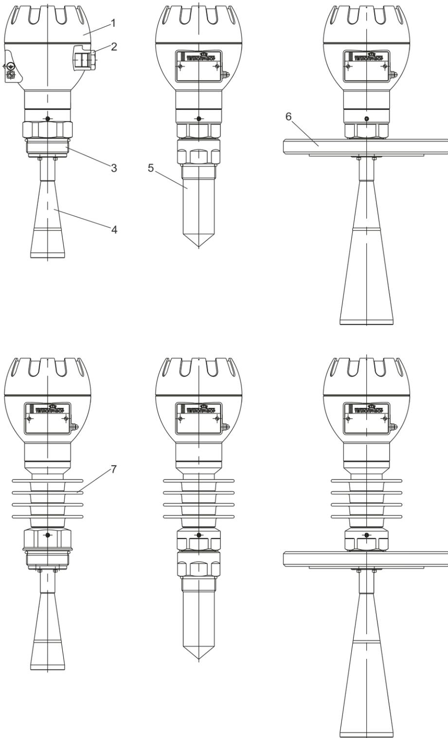
1 – корпус уровнемера; 2 – заглушка кабельного ввода; 3 – подключение к процессу (переходник); 4 – рупорная антенна; 5 – ПП/ PTFE чехол; 6 – подключение к процессу (фланец); 7 – радиатор для высокотемпературных исполнений
